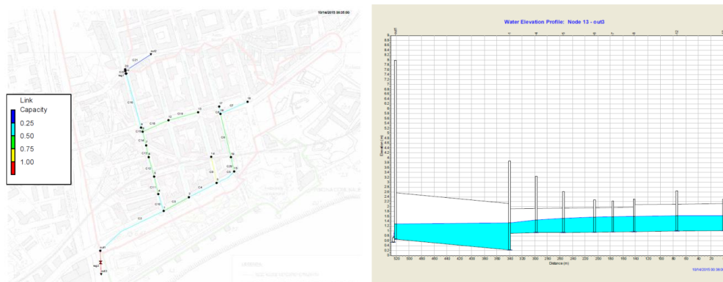
Grado di riempimento dei condotti e profilo dei condotti di Corso Colombo - Via XX Settembre
